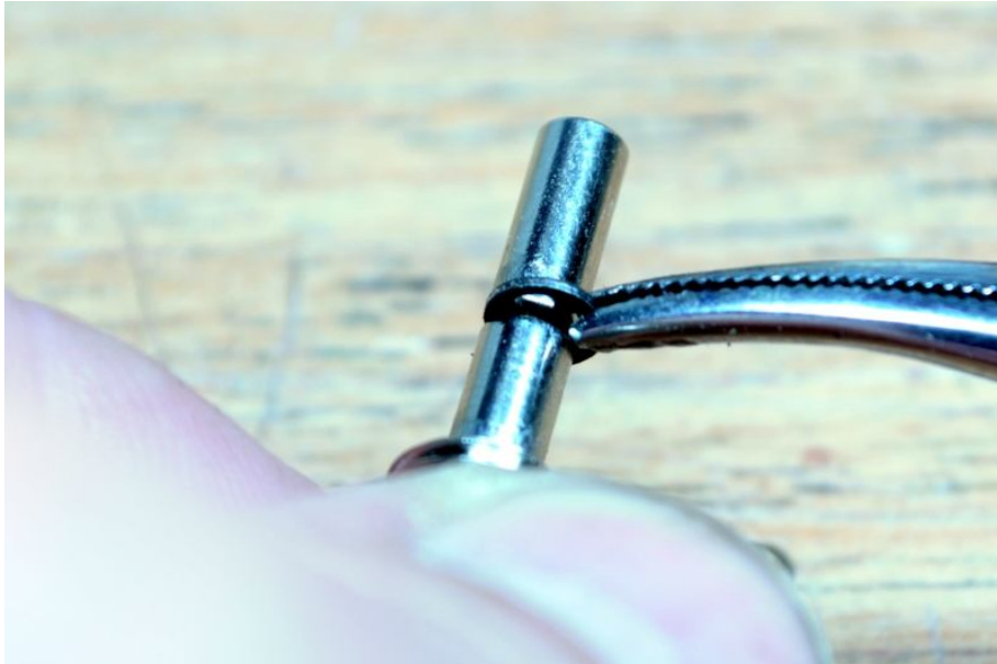
Bild 25: Federring in die Nut setzen
