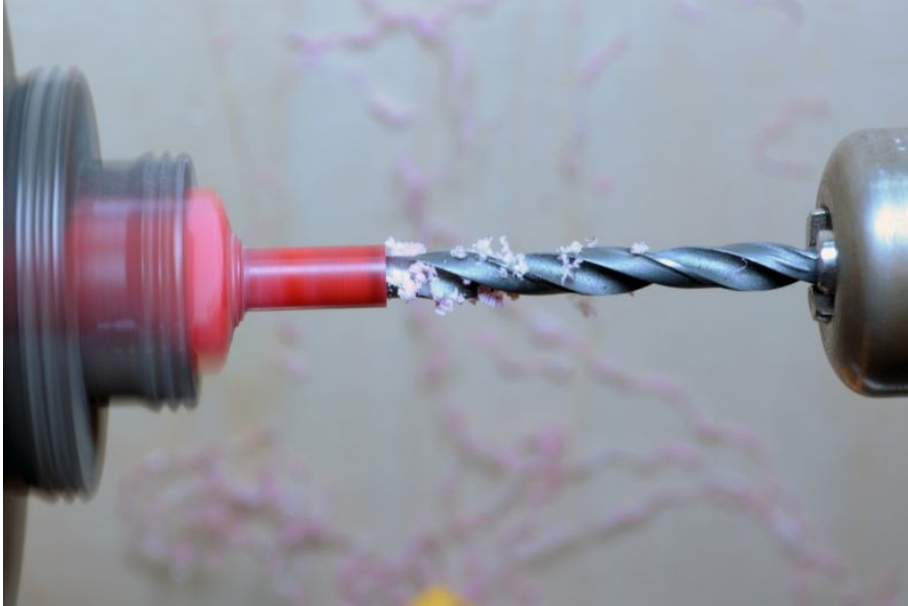
Bild 15: 6 mm Bohrung einbringen. Die Bohrtiefe ergibt sich aus der Länge des abgedrehten Drückers.
