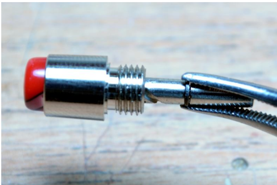
Bild 26: und mit einer kleinen Zange eindrücken – bis sie einrastet (Klick). Fertig – die Mechanik kann jetzt in einem Berlin-Schreiber verbaut werden.
