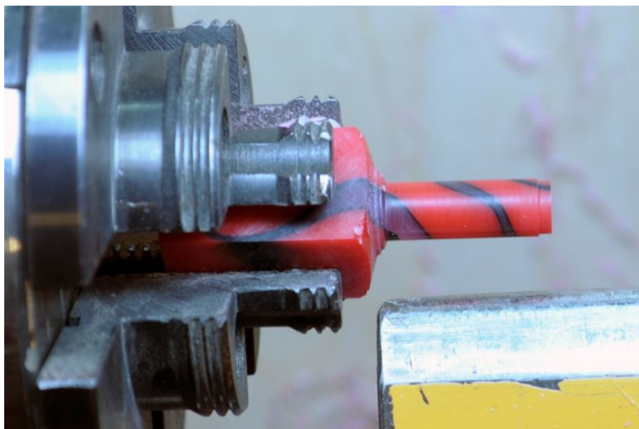
Bild 12: und einen Zapfen mit ca. 8 bis 9 mm drehen
