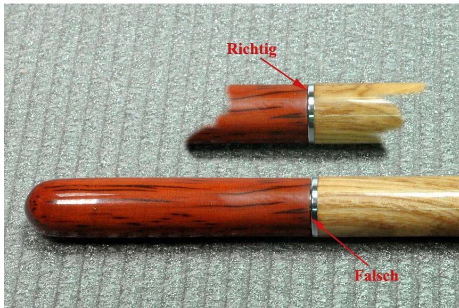
Bild 44-3: Prüfen ob Dichtung schon tief genug eingeschraubt wurde
