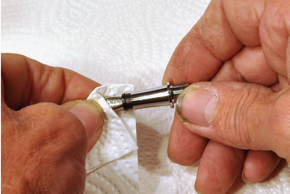
Bild 42: Griffstück mit eingebautem Tintenleitsystem und Schreibfeder, bzw. Patronenroller System
