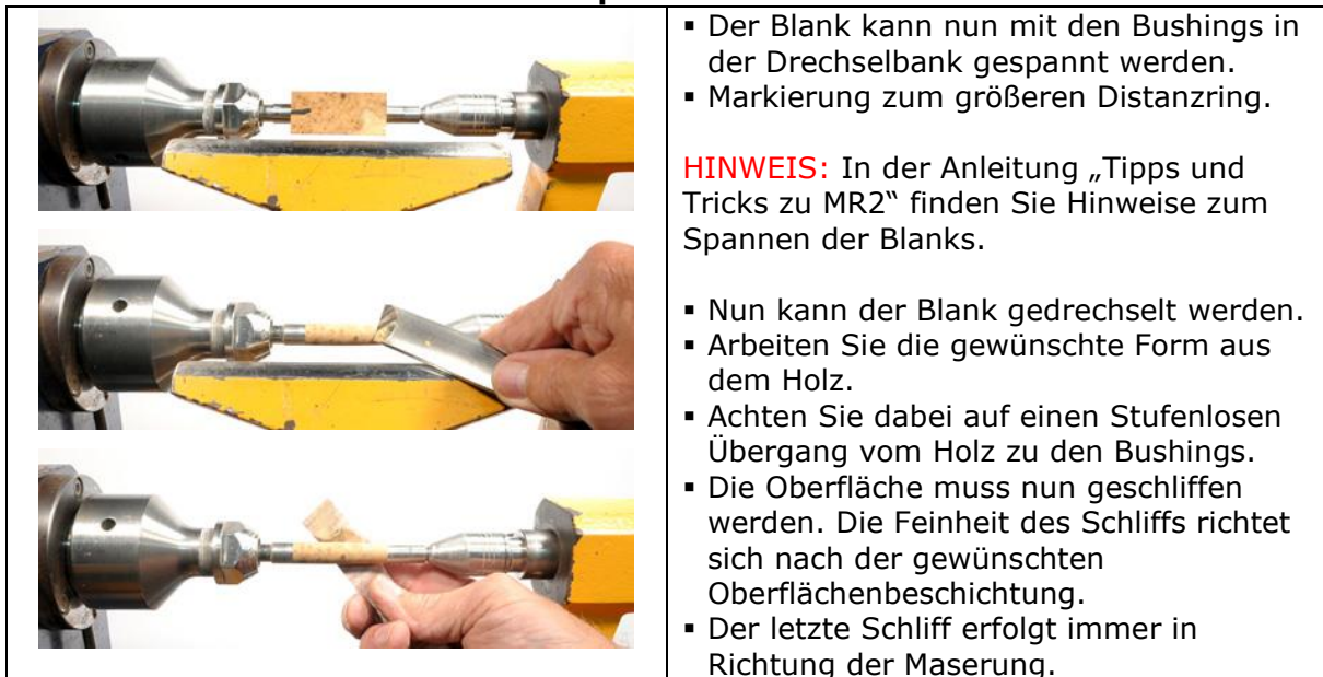
Bild 13: Blank in der Drechselbank spannen und dreheln
