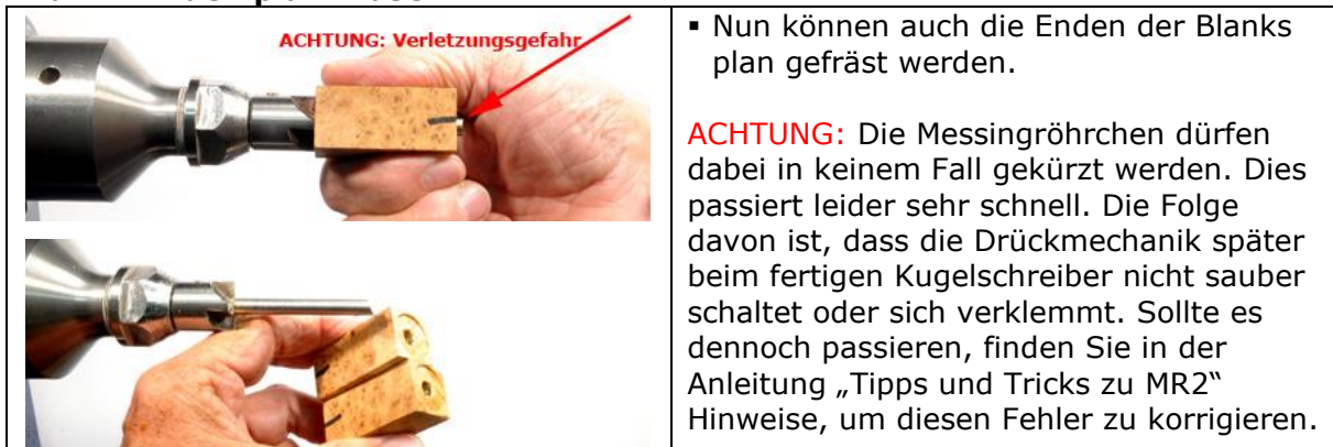
Bild 11: Enden plan Fräsen
